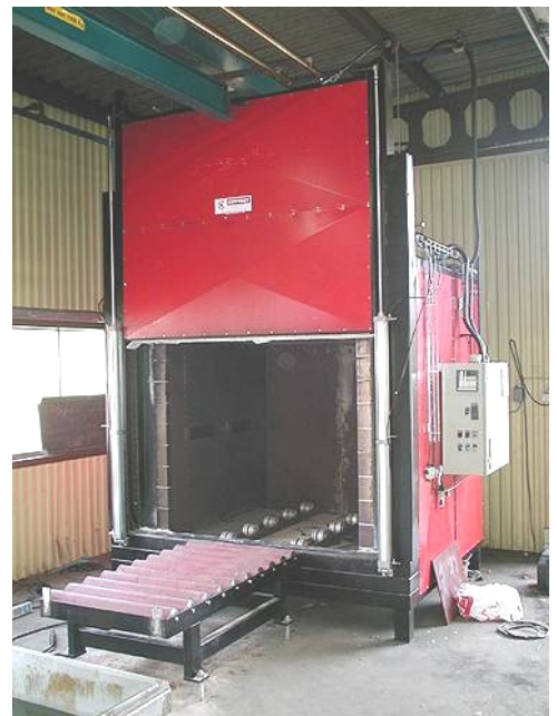
Kammiouuni alumiinin lämpökäsittelyyn
