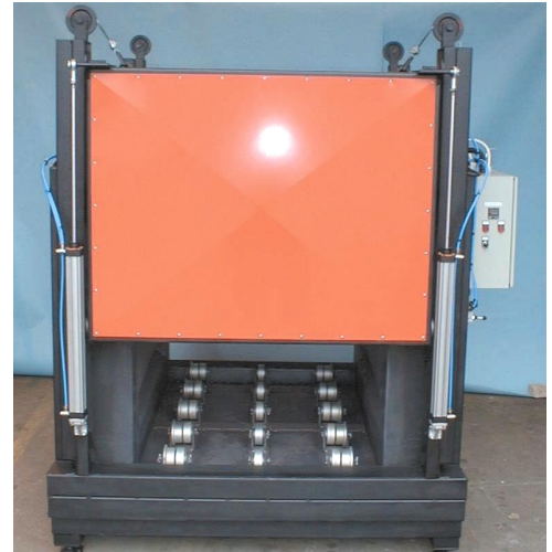
Tunneliuuni jossa arinassa panoksen siirtoa helpottavat rullat
